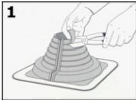
**1** Rohrmanschette mit einem scharfen Messer oder einer Schere auf den gewünschten Rohrdurchmesser zuschneiden. Für einen dichten und festen Sitz sollte die Öffnung je nach Rohrgröße ca. 10 mm – 25 mm kleiner als der Rohrdurchmesser sein.
